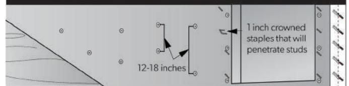
HomeGuard® recomienda el uso de sujetadores de tapa plástica de 1" como mínimo (o grapas de corona de 15/16" como mínimo si se utiliza el Thermo-Ply® u OX-IS® como revestimiento estructural, asegurarse de que el sujetador esté asentado en el montante estructural). Para fijar la envoltura de la casa de manera que quede tensa y plana, el espacio adecuado para estos sujetadores es de 12" a 18" en el centro. Se han impreso marcas de guía cada 8" para ayudar a localizar los montantes.
